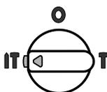
Position zum **Hammerbohren**
