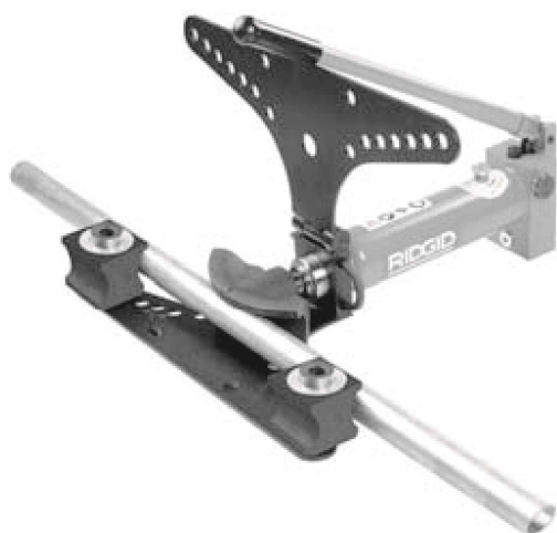
Figura 9 – Colocação do tubo
