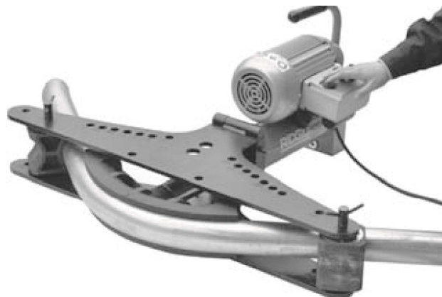
Figura 14 – Trabalhar com o Curvador Eléctrico
