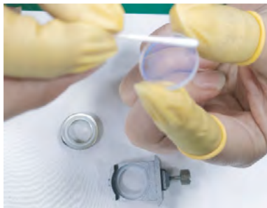
5. Remova o suporte do espelho protetor e limpe-o
