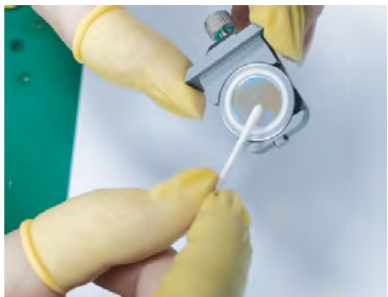
4. Limpe suavemente a lente com um cotonete limpo ou pano limpo embebido em álcool
