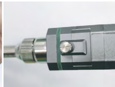
6. Coloque novamente o espelho de proteção no suporte do espelho de proteção, empurre-o para a área do suporte do espelho de proteção e aperte os parafusos
