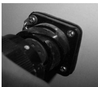
Conexão do cabo com a caixa elétrica
