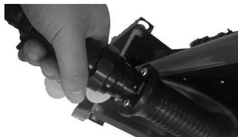
Conexão entre o cabo e a placa de aquecimento
