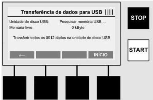
No menu "USB", os protocolos podem ser transferidos da memória interna do aparelho para um dispositivo de memória USB externo.
