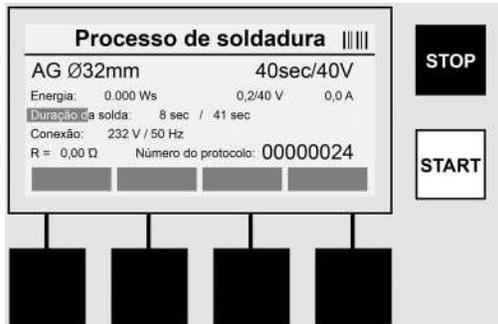
Durante o processo de soldadura, todos os dados relevantes são indicados no ecrã. O processo de soldadura é monitorizado durante todo o tempo de solda de acordo com os parâmetros de soldadura especificados pelo código da manga.
