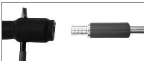
Instalar o novo adaptador manualmente e aparafusar até ao batente e fixar com chave de fendas Torx 15 (15Nm) e, de seguida, remover novamente o pino de fixação.
