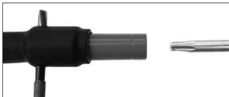
Para substituição dos contactos de encaixe de um perno ou similar ( $\varnothing$  3mm), inserir e fixar lateralmente a união roscada na perfuração. Desaparafusar e remover o adaptador com a chave de fendas Torx 15.
