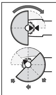
Colocar a capa de protecção **12** sobre a gola do veio, como indicado na figura. As marcas triangulares na tampa de protecção devem coincidir com as respectivas marcas da cabeça da engrenagem.
